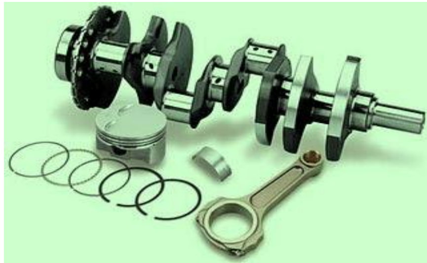
Рис. А.8. Основні деталі кривошипно-шатунного механізму.
