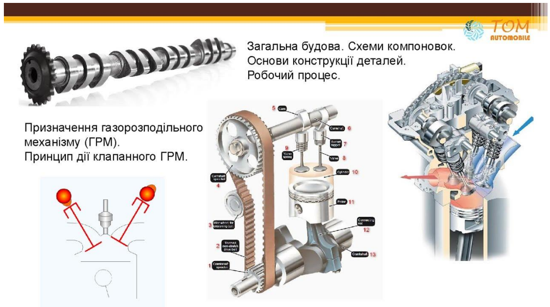
Рис. А.3. Загальна будова ГРМ. Схеми компоновок.
