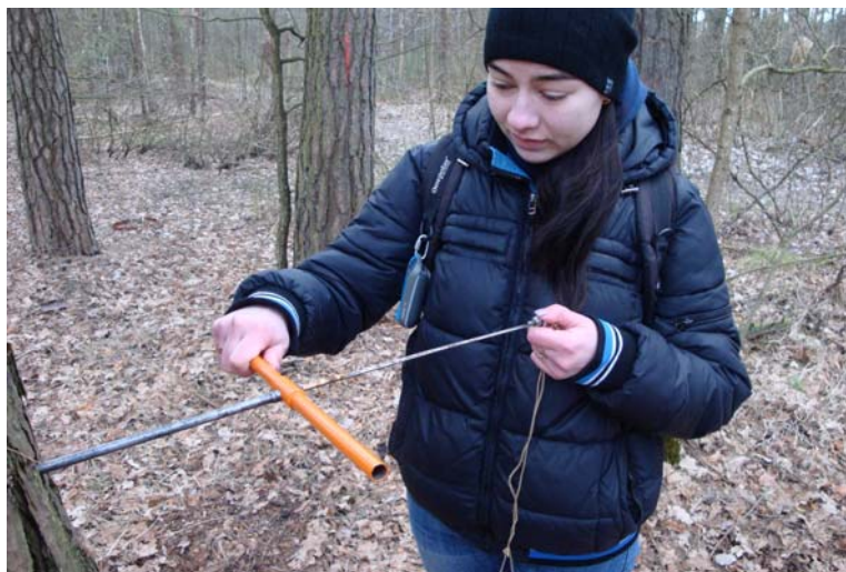
Рис. 5. Віковий бурав Haglof під час досліджень річних приростів сосни звичайної в урочищі Висока Піч Державне підприємство «Зарічанське лісове господарство»
