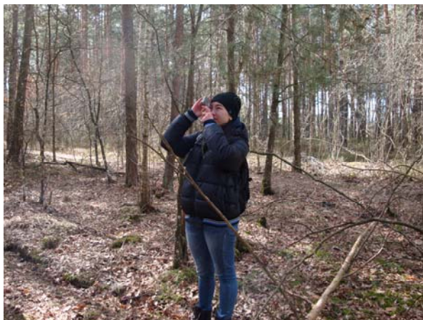
Рис. 4. Оптичний висотомір SUUNTO PM-5/1520 при проведенні таксаційних робіт в умовах урочища Висока Піч
