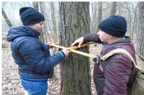
Рис. 1. Електронна мірна вилка Mantax Computer Caliper та класична мірна вилка на таксації лісосіки в урочищі Висока Піч
