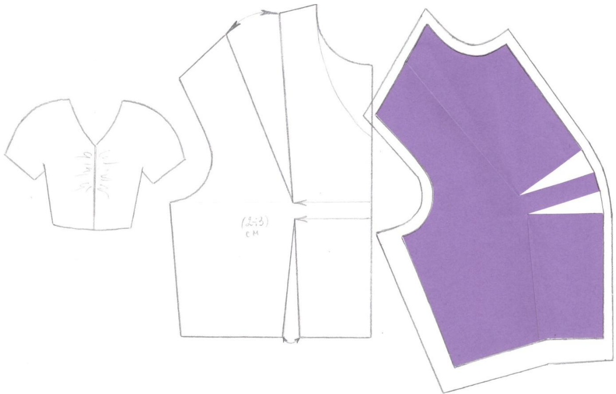
Рисунок 14.8. Перенесення нагрудної виточки в лінію середини пілочки методом макетування (симетрично)
