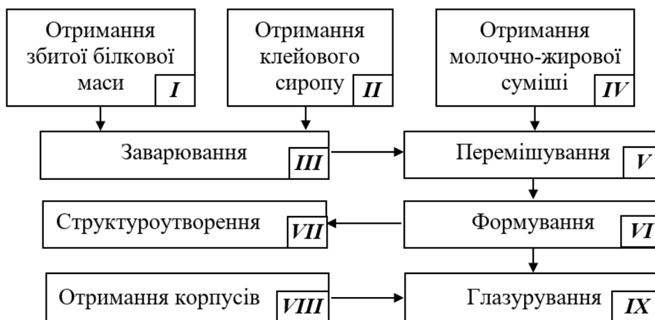
Рис. 1. Принципова схема отримання кремowo-збивних цукерок типу «Пташине молоко» за традиційною технологією
