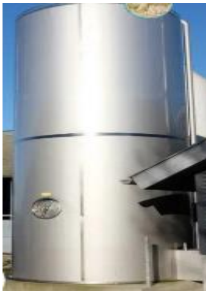
Рис. 2.7. Резервуар для зберігання молока РМД-30
