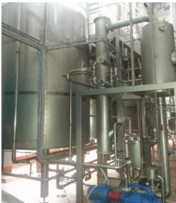
Рис. 2.5. Установа для охолодження і кристалізації згущеного молока з цукром типу «Віганд»
