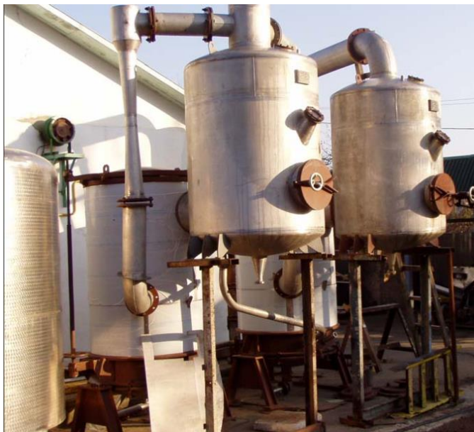
Рис. 2.4. Вакуум-випарний апарат типу «Віганд»
