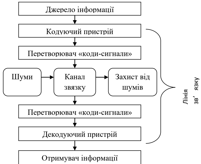
Рис. 1.2. Загальна схема передачі інформації
