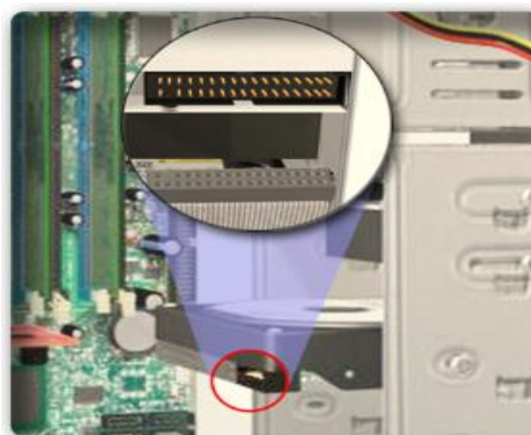
Рис. 5.25. Роз'єм даних для приводу гнучких дисків на приводі гнучких дисків
