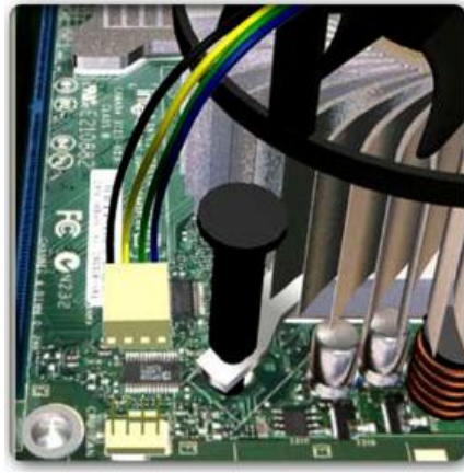
Рис. 5.5. Роз'єм живлення для блоку радіатора і вентилятора
