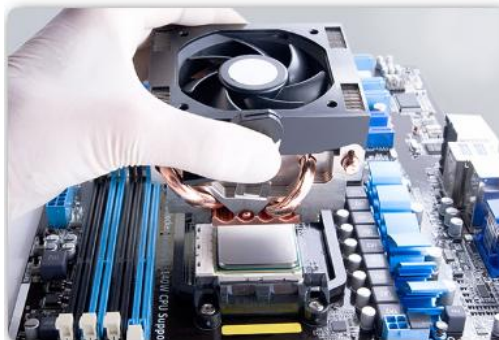
Рис. 5.4. Встановлення блоку радіатора і вентилятора
