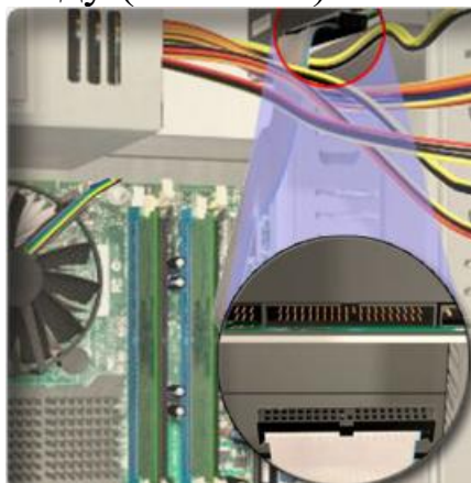
Рис. 5.21. Роз'єм даних РАТА на оптичному приводі
