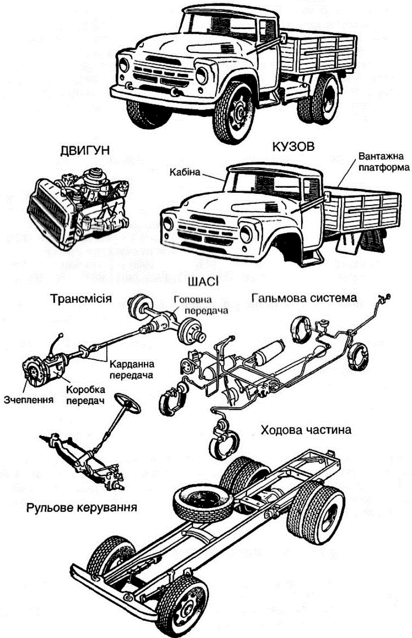
Рис. 1.1. Основні частини вантажного автомобіля
