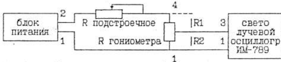
Рис. 11. Схема (потенциметрическая) включения электрогониометра.
