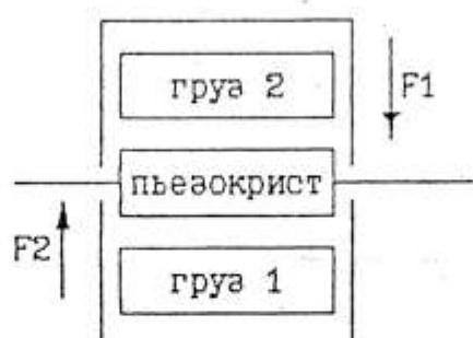
Рис. 9. Принцип действия пьезоакселерометра.
