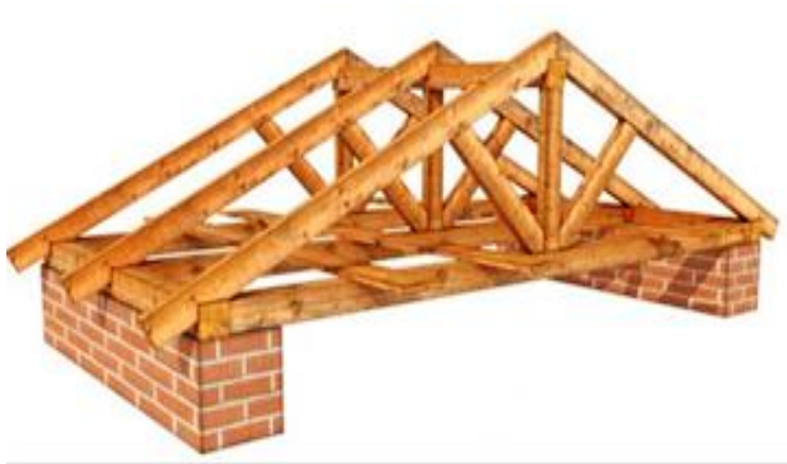
Рис.12.10. Трикутна ферма з дощок
