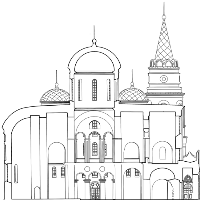
Рис. 4. Чернигов. Спасо-Преображенский собор. Разрез через центральный неф
