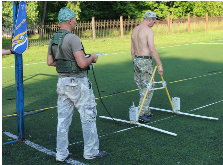
Рис. 4. Пошуки залишків втрачених архітектурних об'єктів за допомогою георадару. Фото надане І.С. Кедуном
