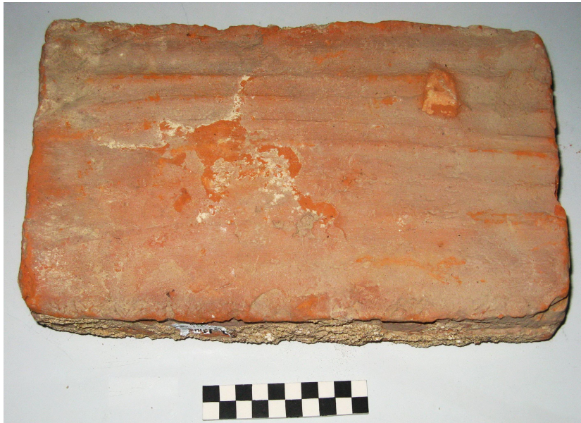
Рис. 41. Цегла-пальчатка з мурування кринти (XVII ст.) у північній прибудові Спасо-Преображенського собору в Чернігові
