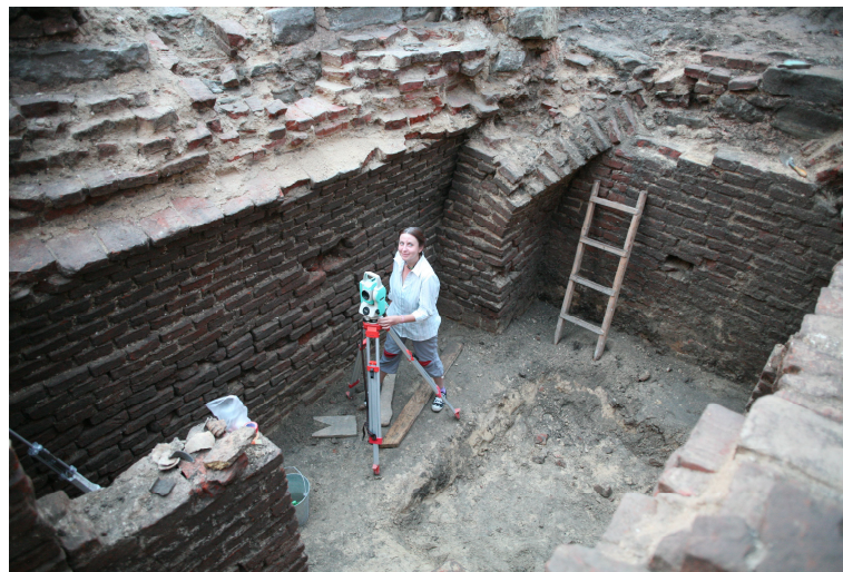
Рис. 11. Обмір крипти XVII ст. у північній прибудові Спасо-Преображенського собору в Чернігові із застосуванням тахіометру. Фото 2012 р.
