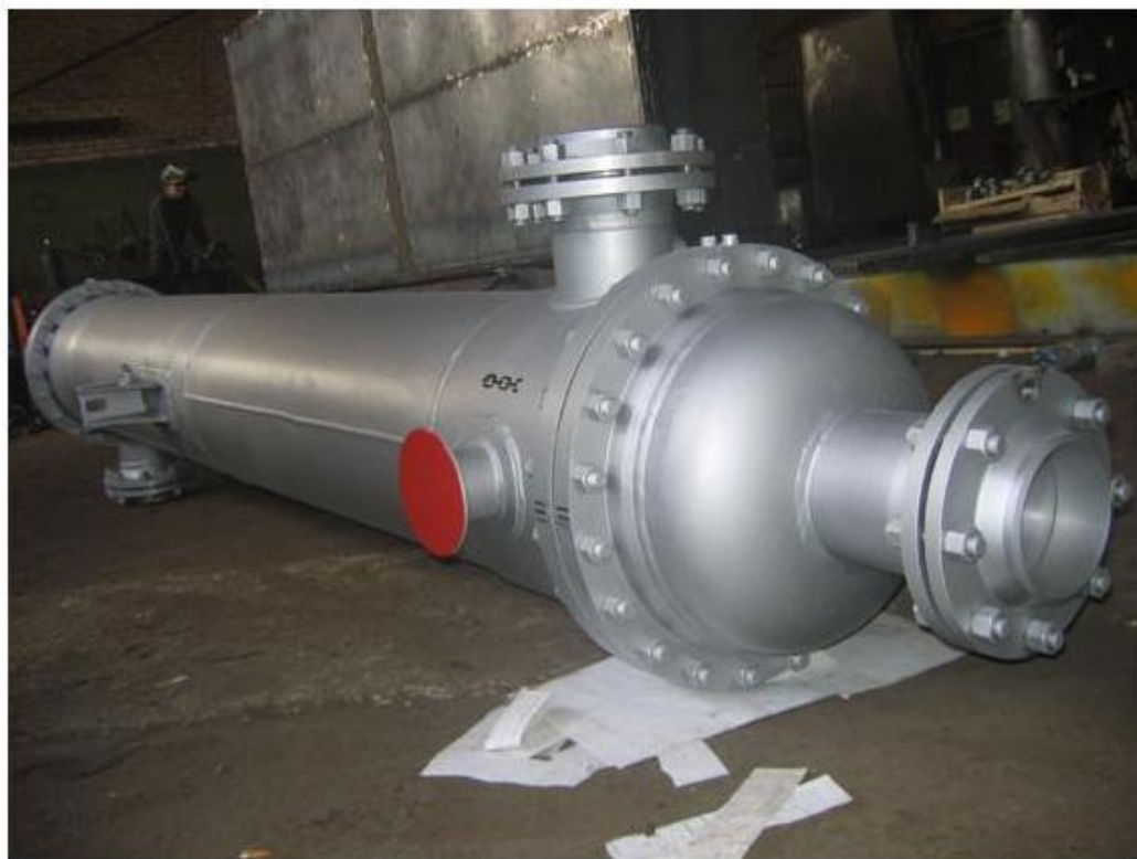
Рис. 2.5 Зовнішній вигляд кожухотрубчастого теплообмінника.
