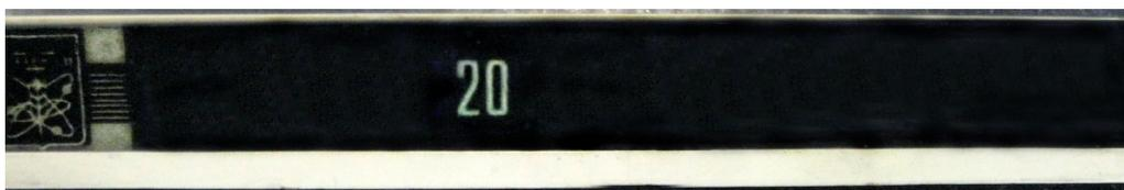
Рис. 5.17. Жидкокристаллический термометр
