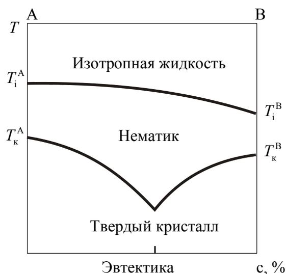
Рис. 1.6. Фазовая диаграмма двухкомпонентной смеси
