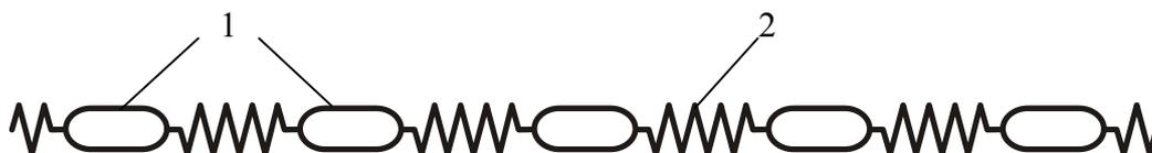
Рис. 8.2. Макромолекула линейного полимера со встроенными мезогенными группами (1 – мезогенные группы; 2 – основная цепь)
