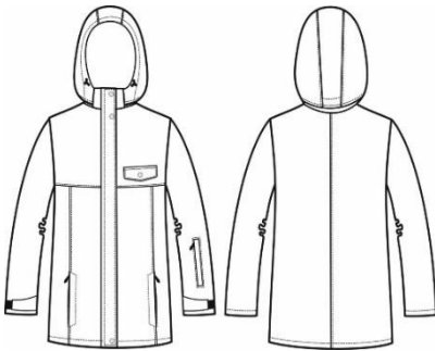
Рис. 10. Технічний рисунок (робочий ескіз) швейного виробу
