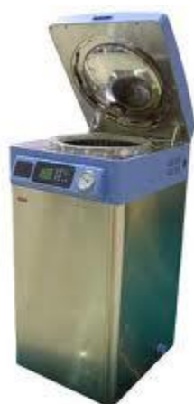
Рисунок 1.2 – Стерилізатори парові (автоклави)
