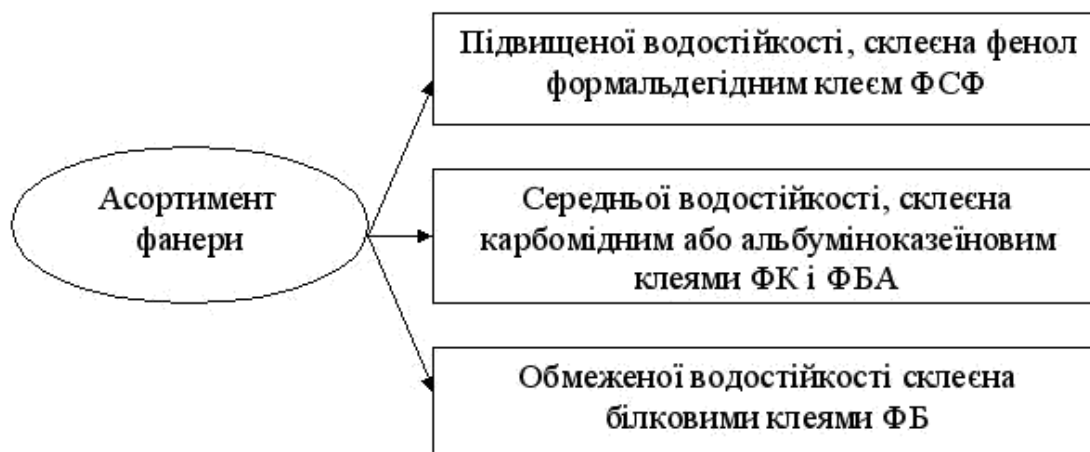
Рисунок 13.10 – Асортимент фанери для виробництва дерев'яної тари
