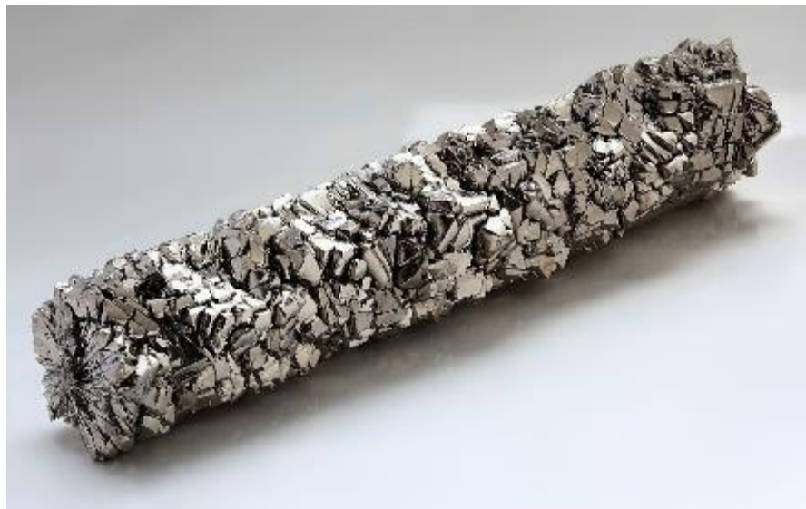
Рисунок 9.1 – Стрижень титанових кристалів високої чистоти (99,995 % Ti)
