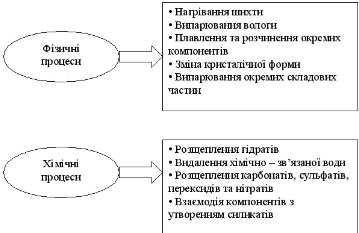
Рисунок 13.5 – Процеси які відбуваються при виробництві скломаси
