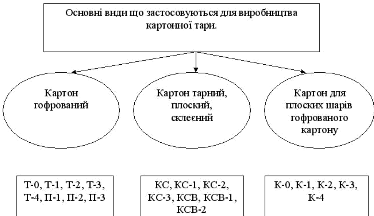
Рисунок 14.1 Основні види картону для виготовлення картонної тари
