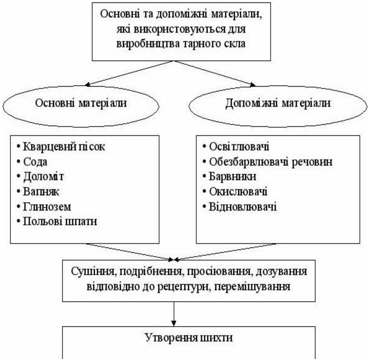
Рисунок 13.4– Матеріали для виробництва скла
