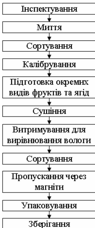
Рис. 1.2. Технологічна схема сушіння плодово-ягідної сировини [29].
