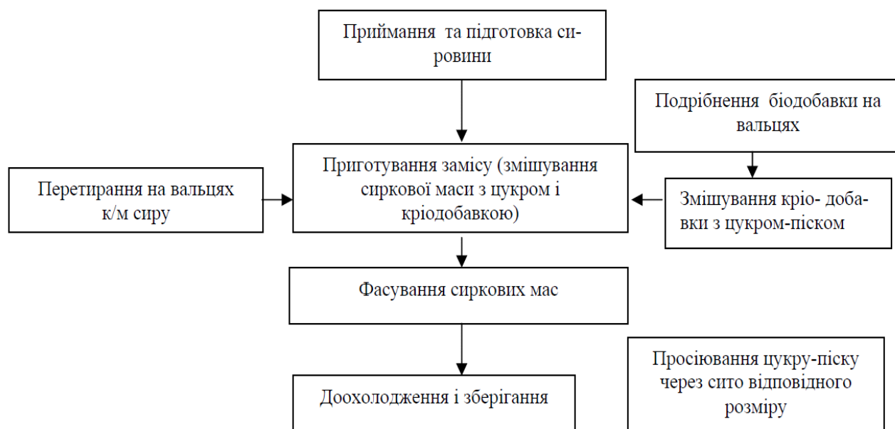
Рис. 4.1. Технологічна схема виготовлення сиру м'якого з кріодобавками [48, 49]
